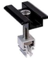
\* 4x Endklemmen 30 mm und 35 mm mit Inbusschraube M8 x 15 mm und Nutenstein
