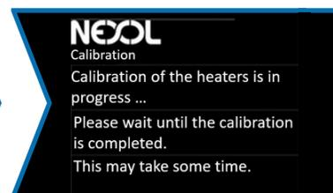
Sobald über einen längeren Zeitraum >500W anliegen, werden Temperatursensoren und Steuerung auf die Installation abgestimmt.
