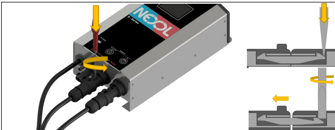
Abbildung 34: Lösen der Steckverbindungen zwischen Einschraubheizkörper und Nexol Energy Controller
