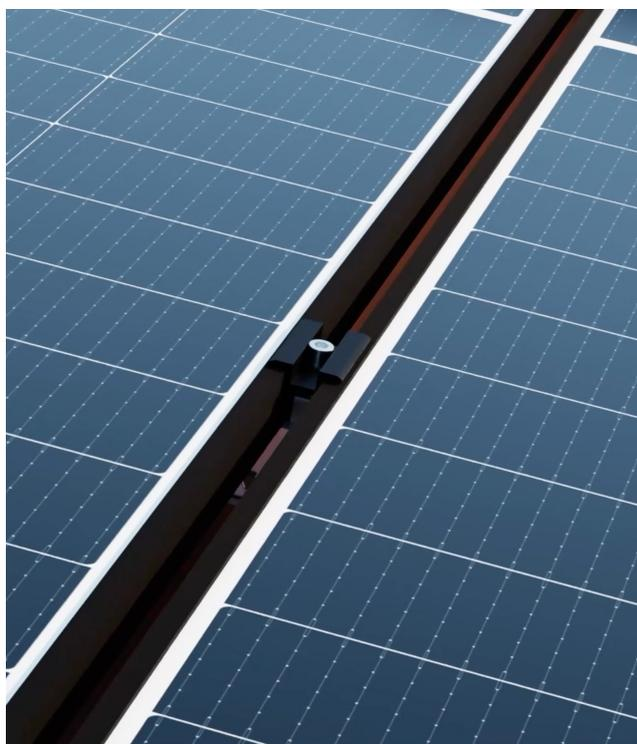
Legen Sie das Modul auf den Schienen ab, schieben es an das zuvor montierte Modul heran und richten es entsprechend aus. Schieben Sie nun 2 weitere Endklemmen in die Aluminiumschienen bis zum Modul heran und fixieren diese mit 16 Nm.
