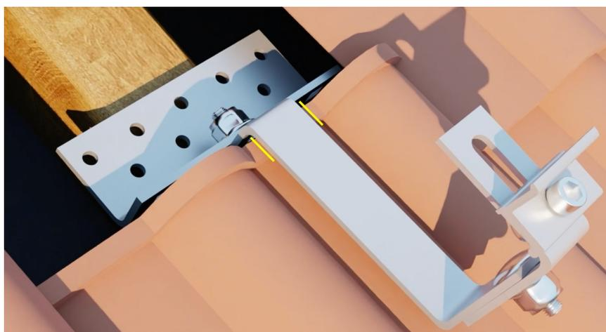
Markieren Sie den Bereich, an dem der S-Bügel aus dem Dach austritt an den Dachziegeln unter und über dem S-Bügel. Schneiden Sie mit einem Winkelschleifer die markierten Bereiche aus, siehe auch Montagevideo.
