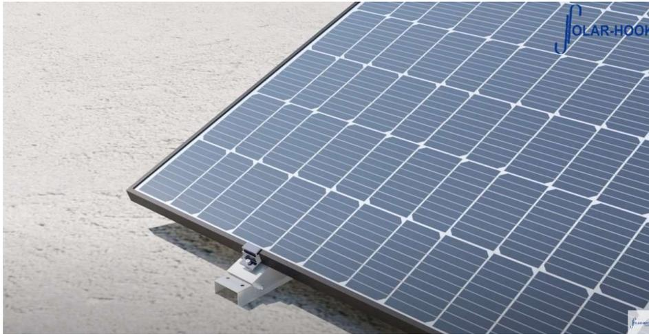
Setzen Sie am oberen Ende der Dreiecke ebenfalls die höhenverstellbare Endklemmen an, und ziehen Sie am Modulrahmen fest. Alle Endklemmen werden mit einem Drehmoment von 10 Nm angezogen.
